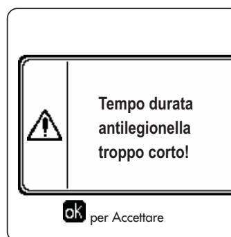
fig. 27 - Messaggio Funzione antilegionella non conclusa
